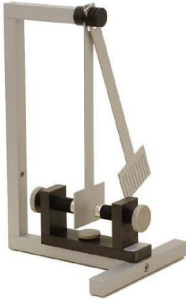
Abb. 5 Versuchsaufbau: „Induzierte Wirbelströme“
