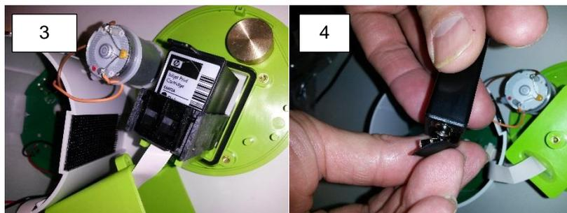
6. Achten Sie dabei darauf, dass Sie das Flachbandkabel der Tintenpatrone nicht verdrehen. Achten Sie beim Verschließen des Pucks auf die Führungsnuten.
