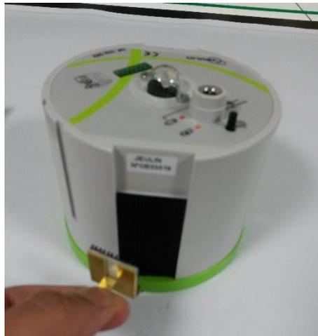
*Ansatzstück mit Klettverschluss zur Befestigung am Puck*
