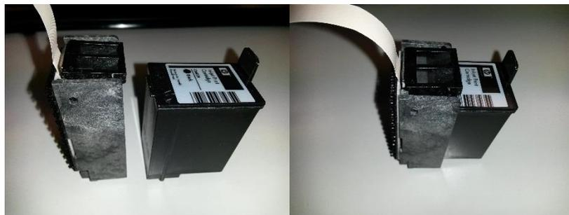
2. Führen Sie den Anschlussstecker durch die Öffnung des L-Winkels und befestigen Sie dann den Tintenpatronenhalter in dem L-Winkel.
