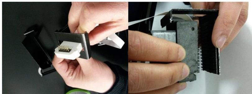
3. Befestigen Sie die Verbindungseinheit mit Klettband an einem Puck und dann mit dem Ring und dem mitgelieferten Gummiband an dem zweiten Puck.
