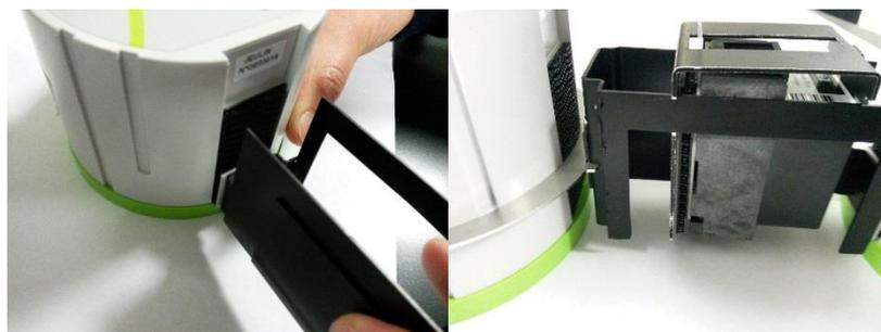
4. Schieben Sie die Tintenpatroneneinheit in die Verbindungseinheit.
