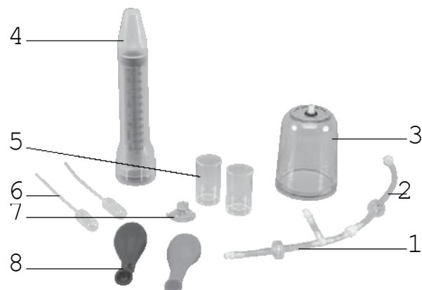
Kit per esperimenti a scopo di training per introdurre i principi della fisica del vuoto. Possono ad esempio essere eseguiti i seguenti esperimenti:
