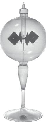
O radiômetro de Crookes serve para a demonstração da transformação de energia radiante em energia cinética.
