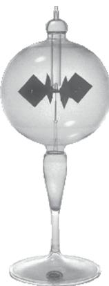
Il radiometro di Crookes serve per dimostrare la conversione dell'energia radiante in energia cinetica.
